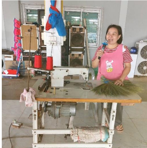
นางวริญญา งอยภูธร บรรยายให้ความรู้เทคนิคการเย็บดอกเข็มให้เป็นชิ้นส่วนประกกัน โดยใช้จักรเย็บผ้า เพื่อให้ไม้กวาดมีความแน่นหนาและใช้งานคงทน
