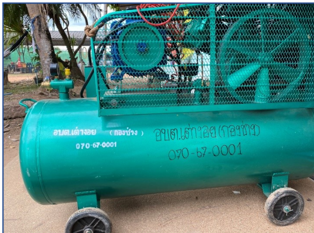
๖. ครุภัณฑ์ก่อสร้าง ปัมลม ถังม ขนาด ๓๐๐ ลิตร ๔ แรงม้า มอเตอร์ ๓ สูบ
